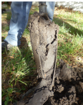
Arcilla de color grisáceo con porcentaje variable de arena. Por debajo de 3 a 4 m, contiene clastos cuarzosos de diferente tamaño. .
